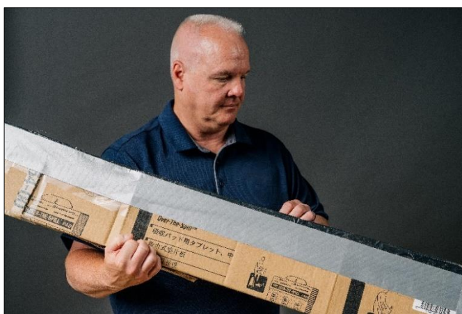
Figure 3-24. How to Hold a Chute for the Pour
