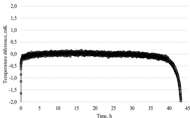
Fig. 1. INM Zn2019-01 freezing Plateau
