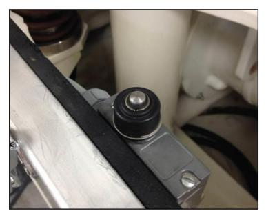
Figure 24. Cryomill Safety Button
