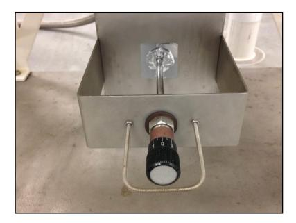
Figure 27. LN<sub>2</sub> Control Valve Box
