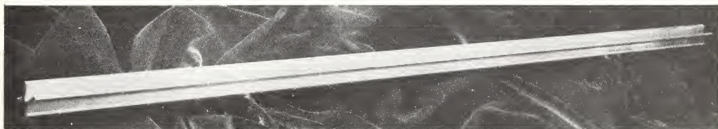
FIGURE 1. U. S. National Prototype Meter 27.
