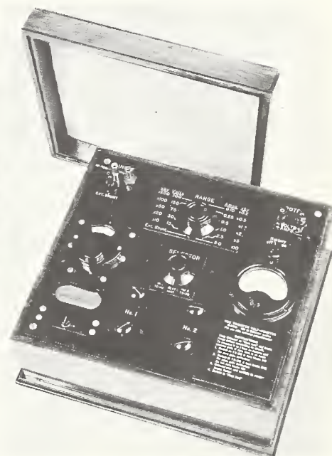
Fig. 4. NBS Volt Ampere Converter
