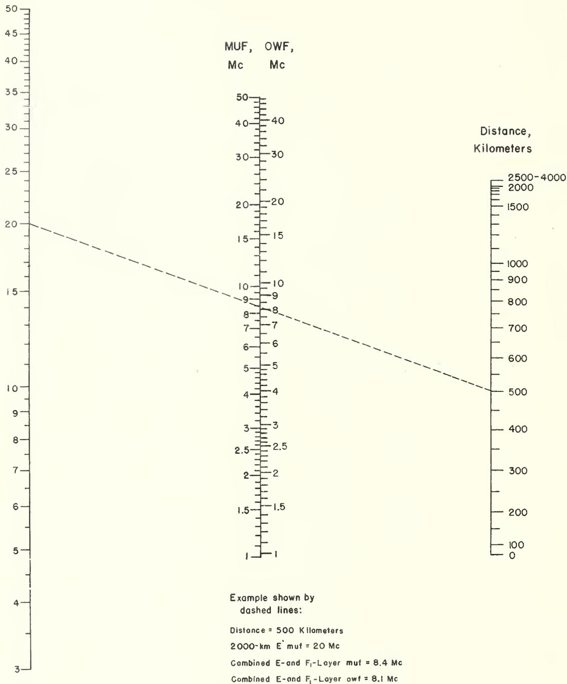
FIG.12. NOMOGRAM FOR TRANSFORMING E-LAYER 2000-MUF TO EQUIVALENT MAXIMUM USABLE FREQUENCIES AND OPTIMUM WORKING FREQUENCIES DUE TO COMBINED EFFECT OF E LAYER AND  $F_1$  LAYER AT OTHER TRANSMISSION DISTANCES.
