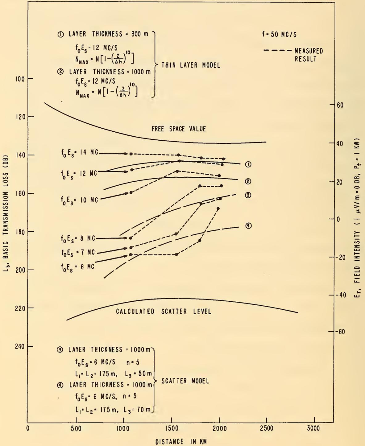
THEORETICAL EXPLANATION FOR A RELATIONSHIP BETWEEN f<sub>0</sub>E<sub>s</sub> AND E<sub>s</sub> FIELD INTENSITY
