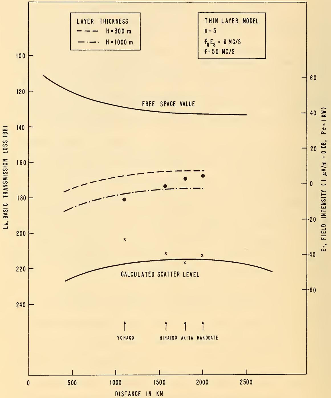
DISTANCE DEPENDENCE OF SPORADIC E PROPAGATION (THIN LAYER MODEL)
