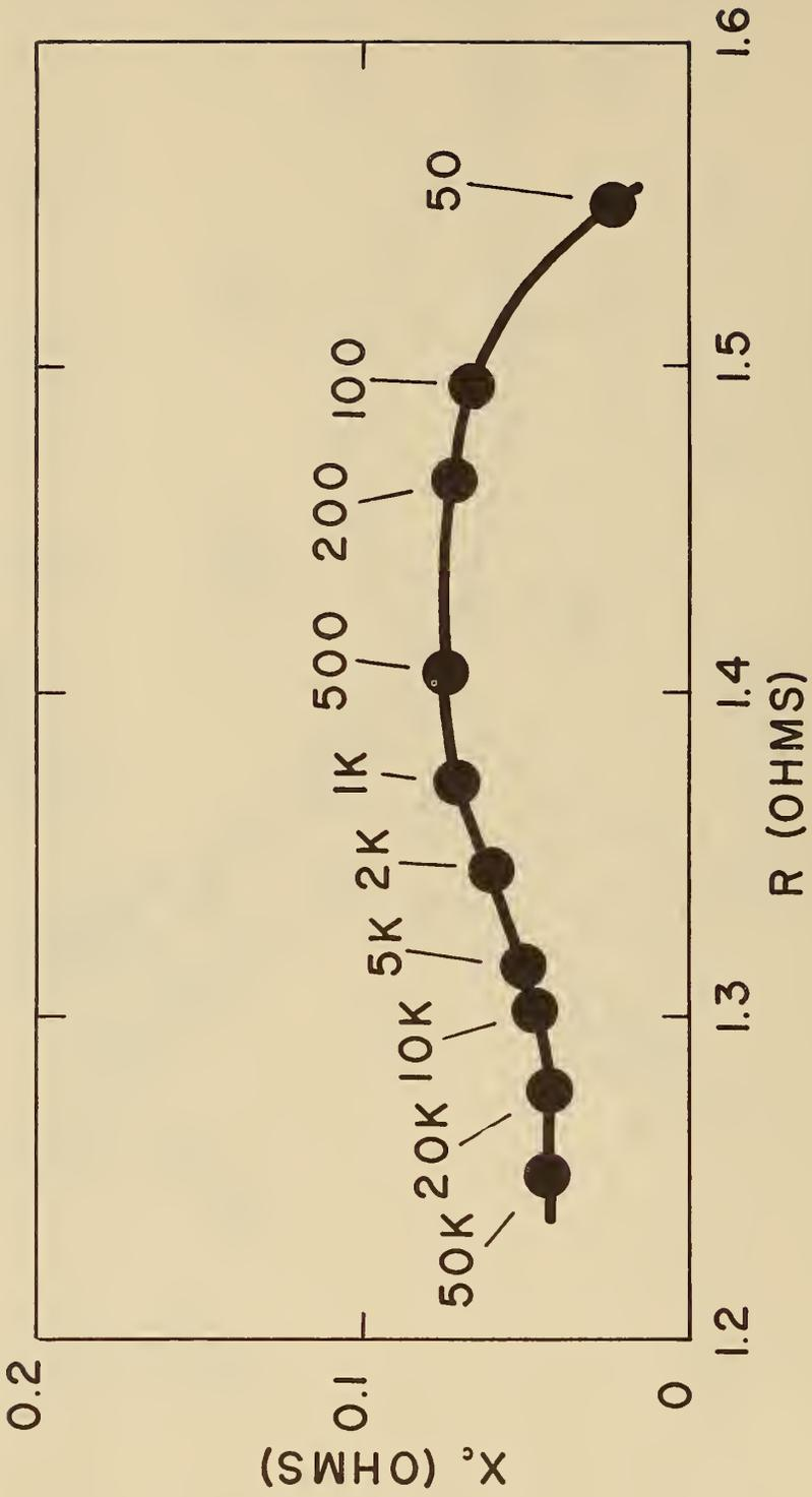
FIG. 21 RESISTANCE-REACTANCE CURVE OF C-SIZE CELLS OF BRAND 4 AFTER 4-OHM TEST
