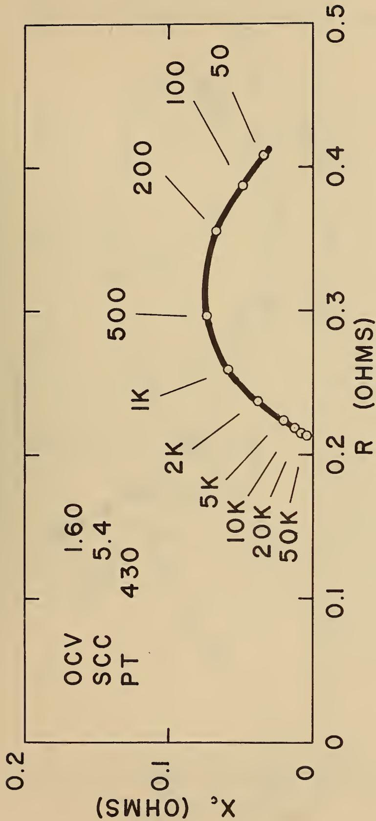
FIG. 10 RESISTANCE-REACTANCE CURVE OF C-SIZE CELLS OF BRAND 1 BEFORE DISCHARGE
