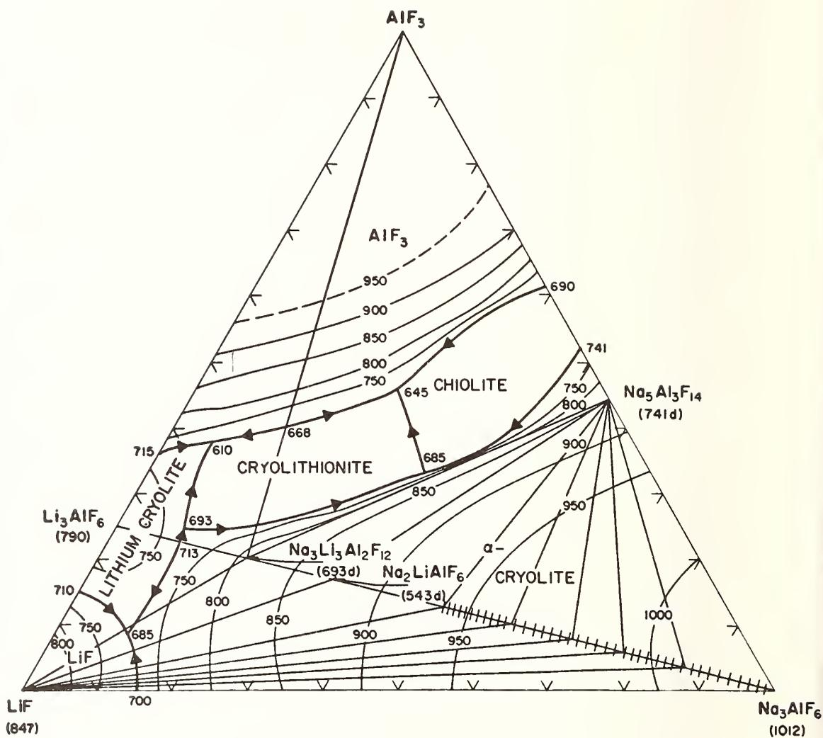
Figure 22. System  $\text{LiF}-\text{AlF}_3-\text{Na}_3\text{AlF}_6$  (106).
