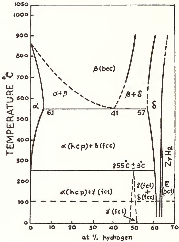
FIG.6. THE EQUILIBRIUM PHASE RELATIONS IN ZIRCONIUM-HYDROGEN SYSTEM
