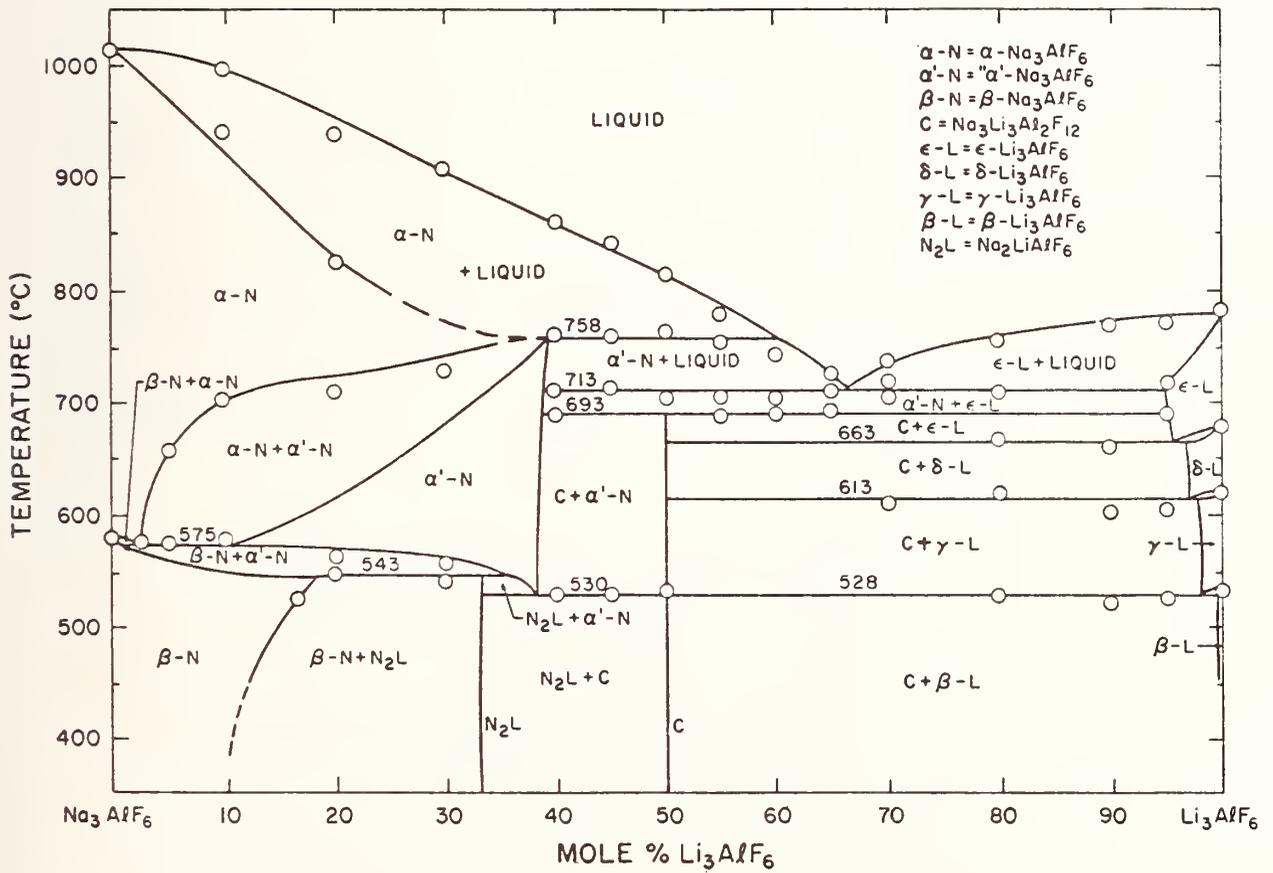
Figure 11. System  $\text{Na}_3\text{AlF}_6\text{-Li}_3\text{AlF}_6$  (89).
