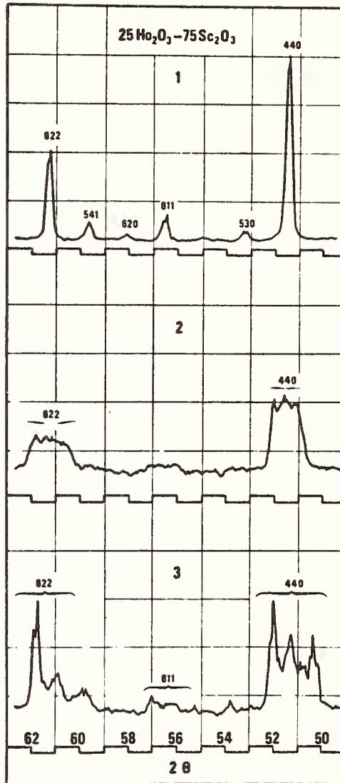
**Fig. 3** - Evolution de la largeur des raies de diffraction enregistrées pour un échantillon de composition 25 mole %  $\text{Ho}_2\text{O}_3$  - 75 mole %  $\text{Sc}_2\text{O}_3$  en fonction des conditions de traitement thermique.
