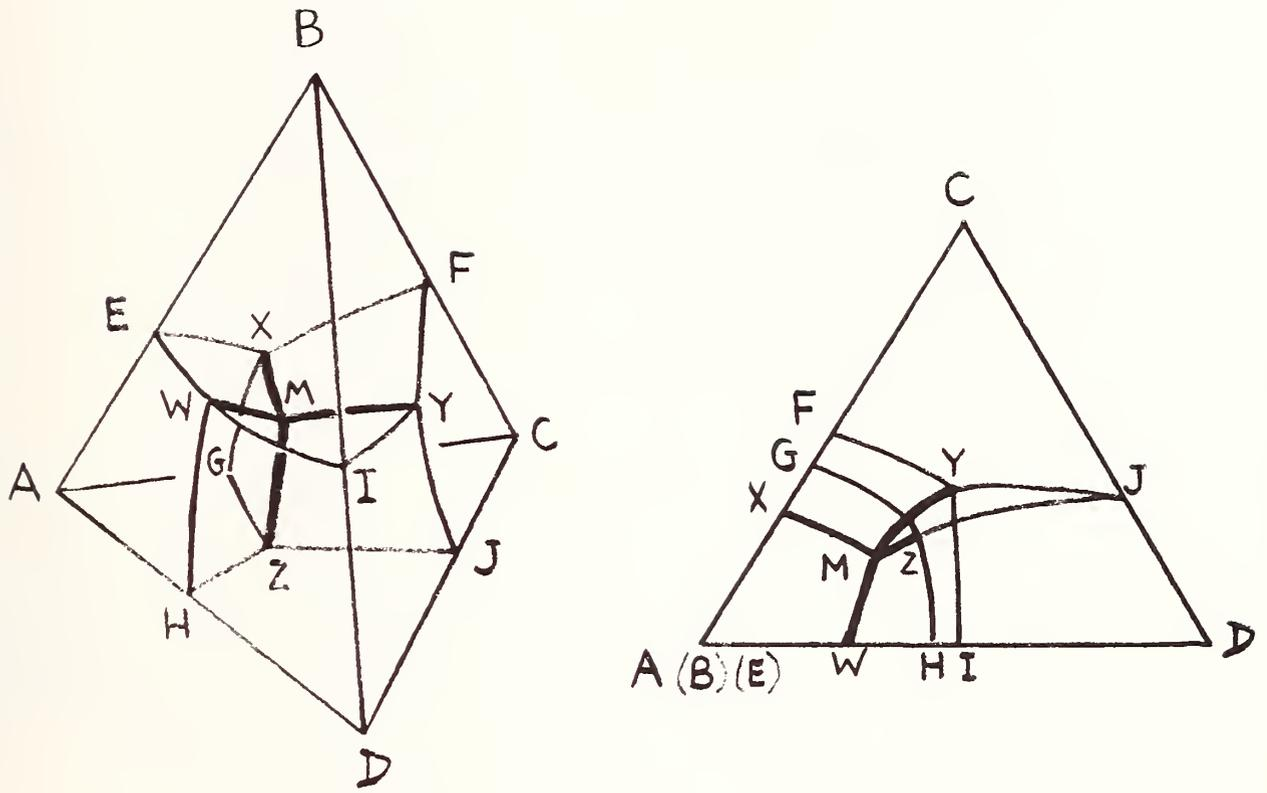
FIGURE 12. PEREL'MAN OPTIMAL PROJECTION OF A SIMPLE QUATERNARY SYSTEM.
