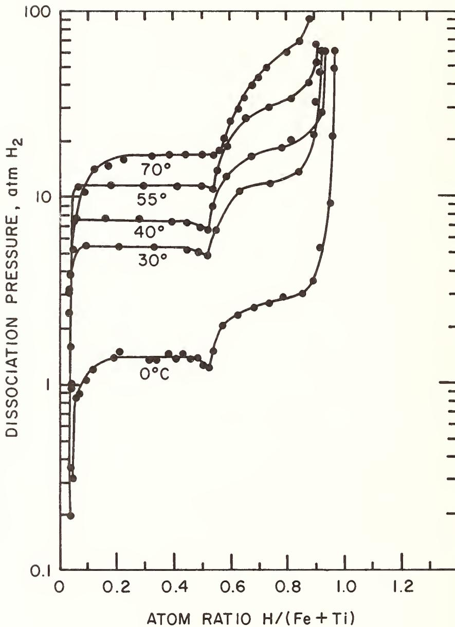
**FIGURE II - PRESSURE-COMPOSITION ISOTHERMS FOR THE FeTi-H SYSTEM.**
