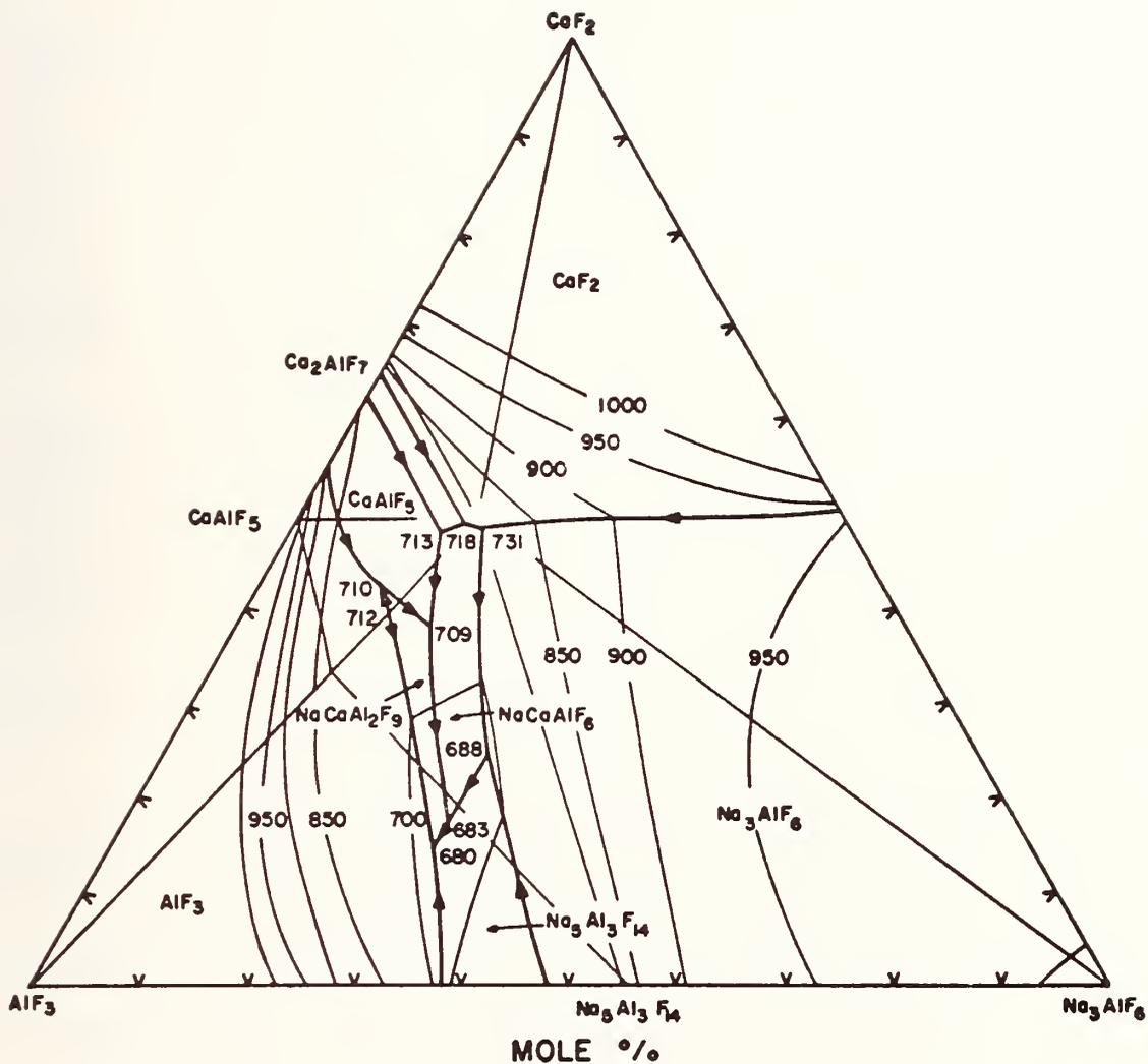
Figure 17. System  $\text{CaF}_2$ - $\text{AlF}_3$ - $\text{Na}_3\text{AlF}_6$  (56).
