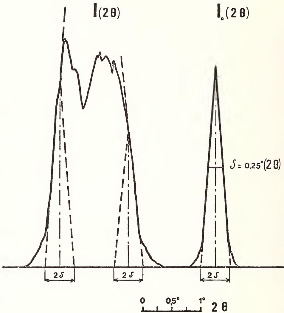
Fig. 1 - Schema de la détermination des composantes extrêmes d'une "raie" de diffraction enregistrée. La raie  $I(2\theta)$  est l'enveloppe d'une série de raies élémentaires de profil  $I_0(2\theta)$ .
