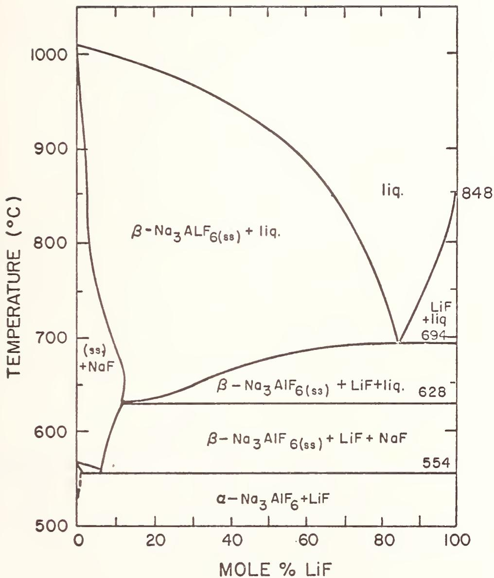
Figure 9. System  $\text{Na}_3\text{AlF}_6$ - $\text{LiF}$ <sup>(42)</sup>.
