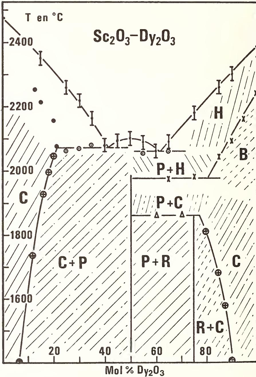
**Fig. 9** Domaines d'existence des différentes phases observées (hachures).
