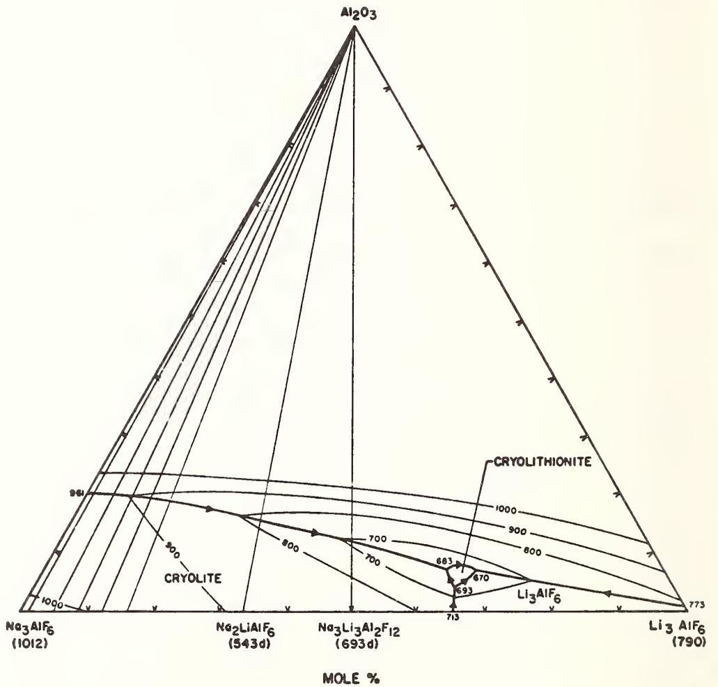
Figure 20. System  $\text{Li}_3\text{AlF}_6$ - $\text{Na}_3\text{AlF}_6$ - $\text{Al}_2\text{O}_3$  (90).
