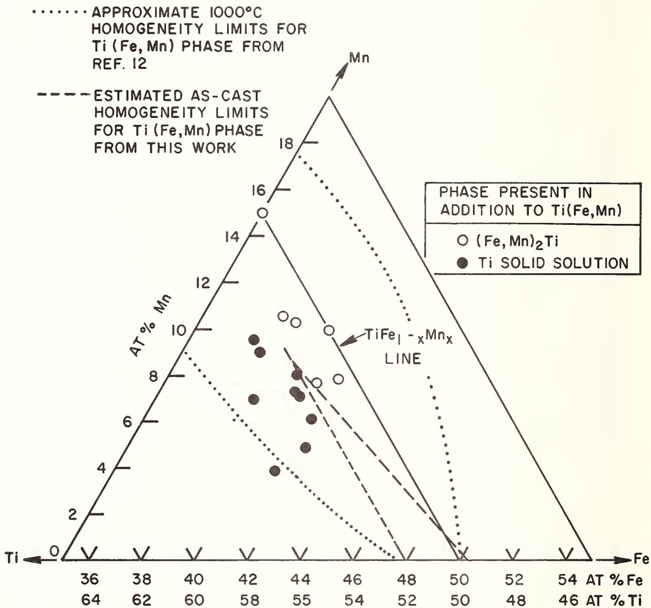
**FIGURE 9** - Ti-Fe-Mn ALLOYS STUDIED IN AS-CAST
