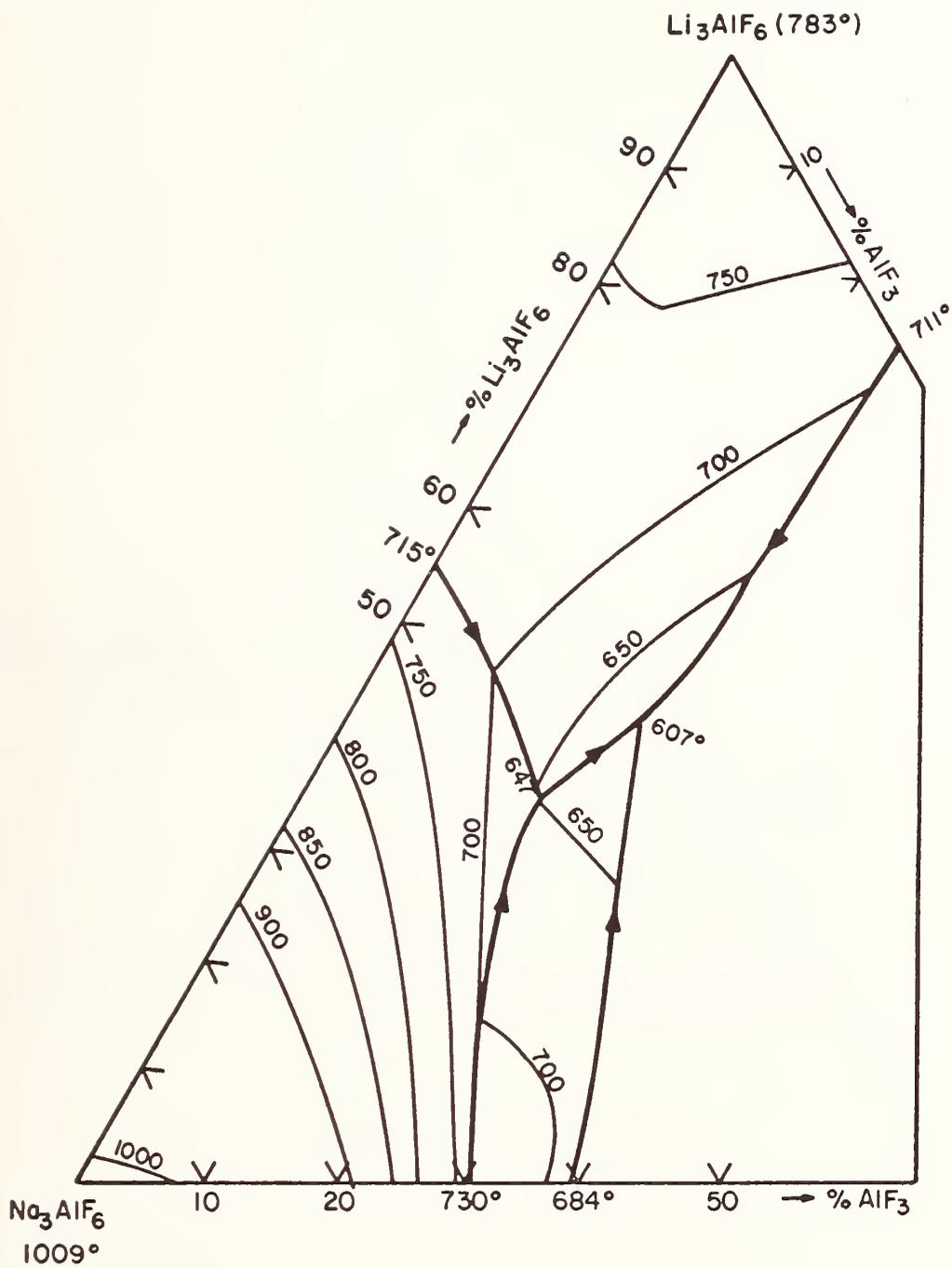
Figure 21. System  $\text{Na}_3\text{AlF}_6$ - $\text{Li}_3\text{AlF}_6$ - $\text{AlF}_3$  (69).
