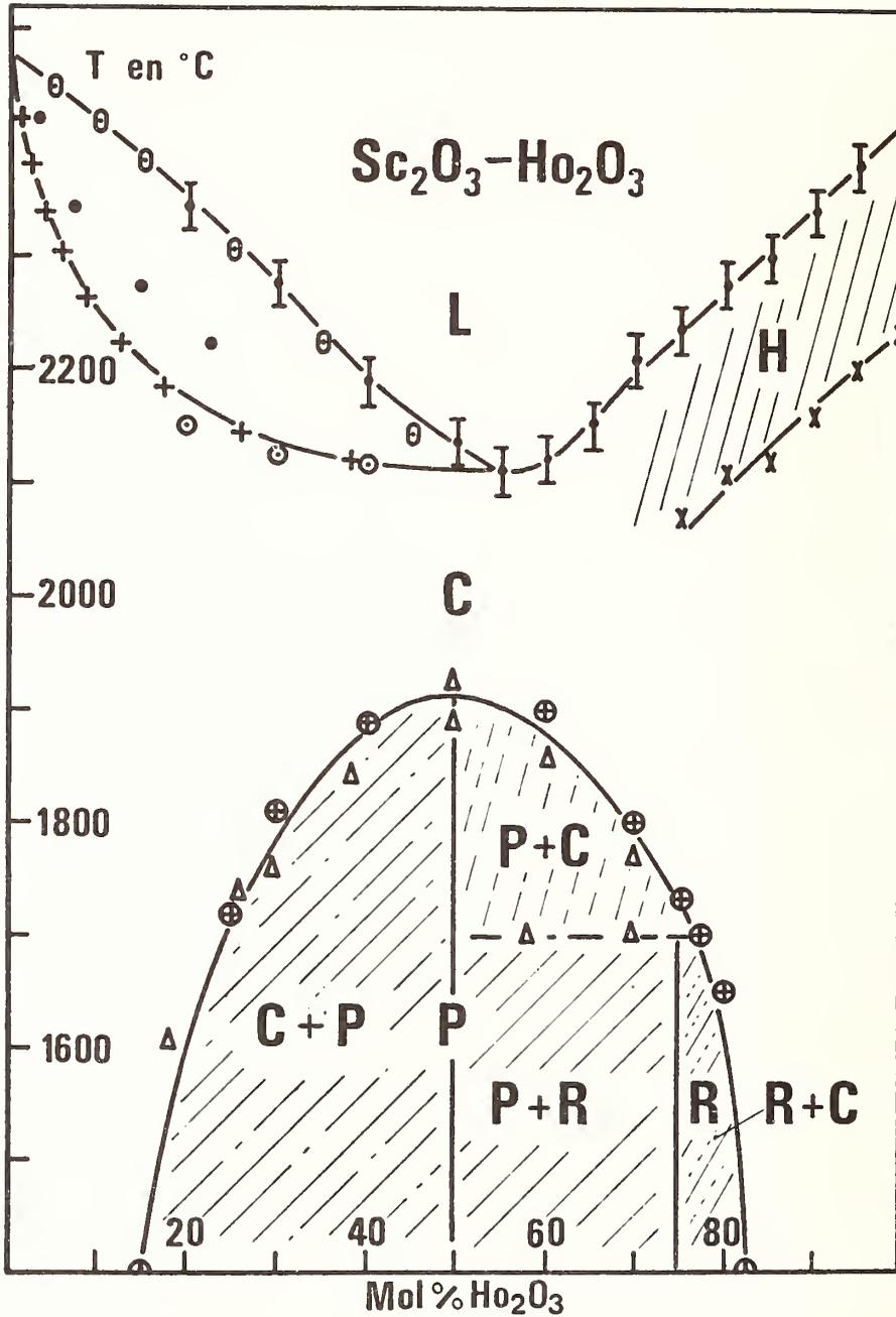
**Fig. 5** - Domaines d'existence des différentes phases observées. Résultats expérimentaux et calculés :
