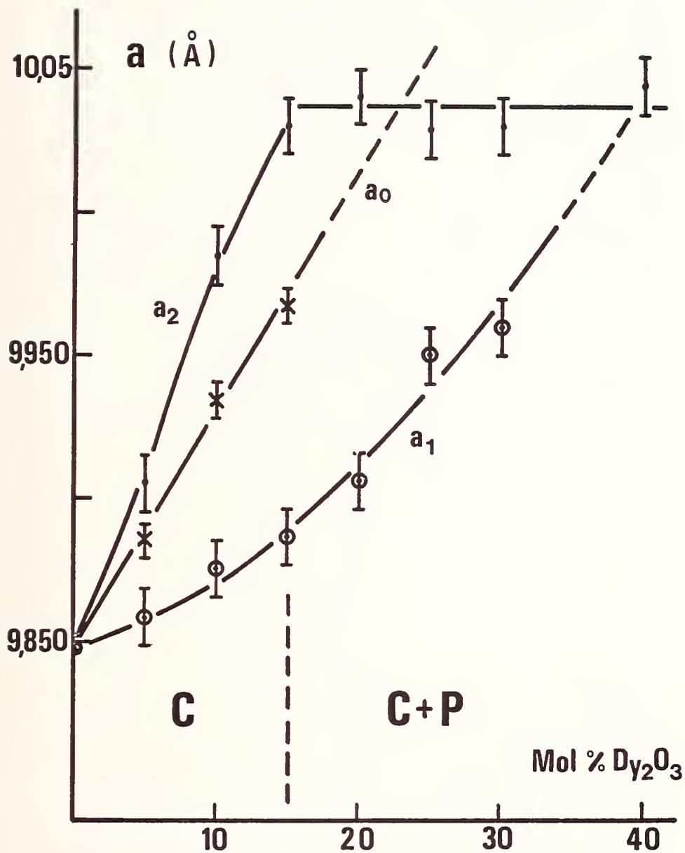
**Fig. 8** - Evolution des paramètres  $a_1$  et  $a_2$  des solutions solides cubiques extrêmes présentes dans les produits fondus trempée en fonction de leur composition globale. Ces valeurs sont comparées à celles du paramètre  $a_0$  de la solution homogène obtenue par trempe du solide à l'équilibre à haute température.
