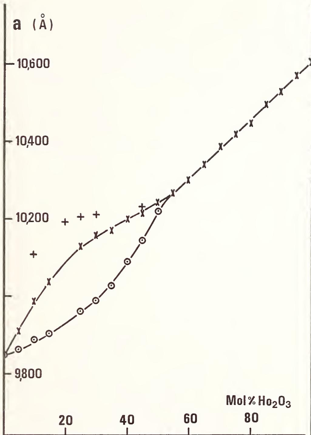
Fig. 4 - Evolution des paramètres  $a_1$  et  $a_2$  des solutions solides cubiques extrêmes dans les produits fondus en fonction de la composition globale des mélanges pour le système  $Sc_2O_3-Ho_2O_3$ . Vitesses de déplacement de l'interface solide liquide :  $v = 10$  mm/s (x, o) et  $v = 0,005$  mm/s (+, o).
