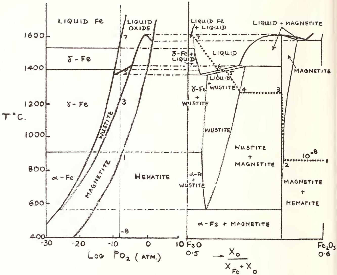
FIGURE 21a) PHASE STABILITY DIAGRAM FOR THE Fe-O SYSTEM.
