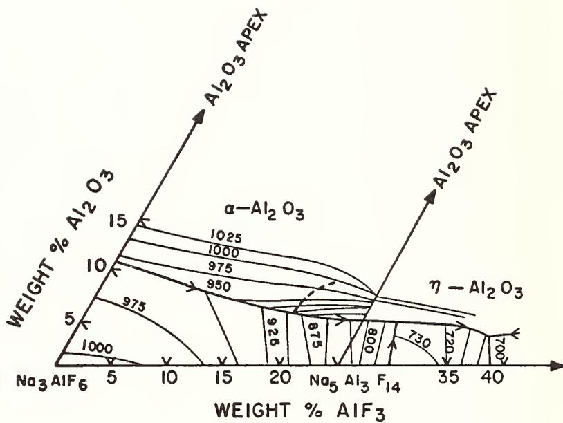
Figure 18. System  $\text{Na}_3\text{AlF}_6$ - $\text{AlF}_3$ - $\text{Al}_2\text{O}_3$  (104).
