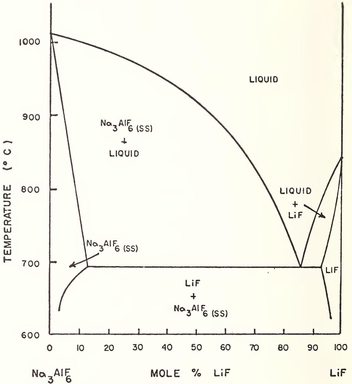
Figure 10. System  $\text{Na}_3\text{AlF}_6$ - $\text{LiF}$ <sup>(41)</sup>.
