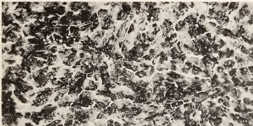
Figure 1. NBS-SRM 1175, white cast iron. (X500).
