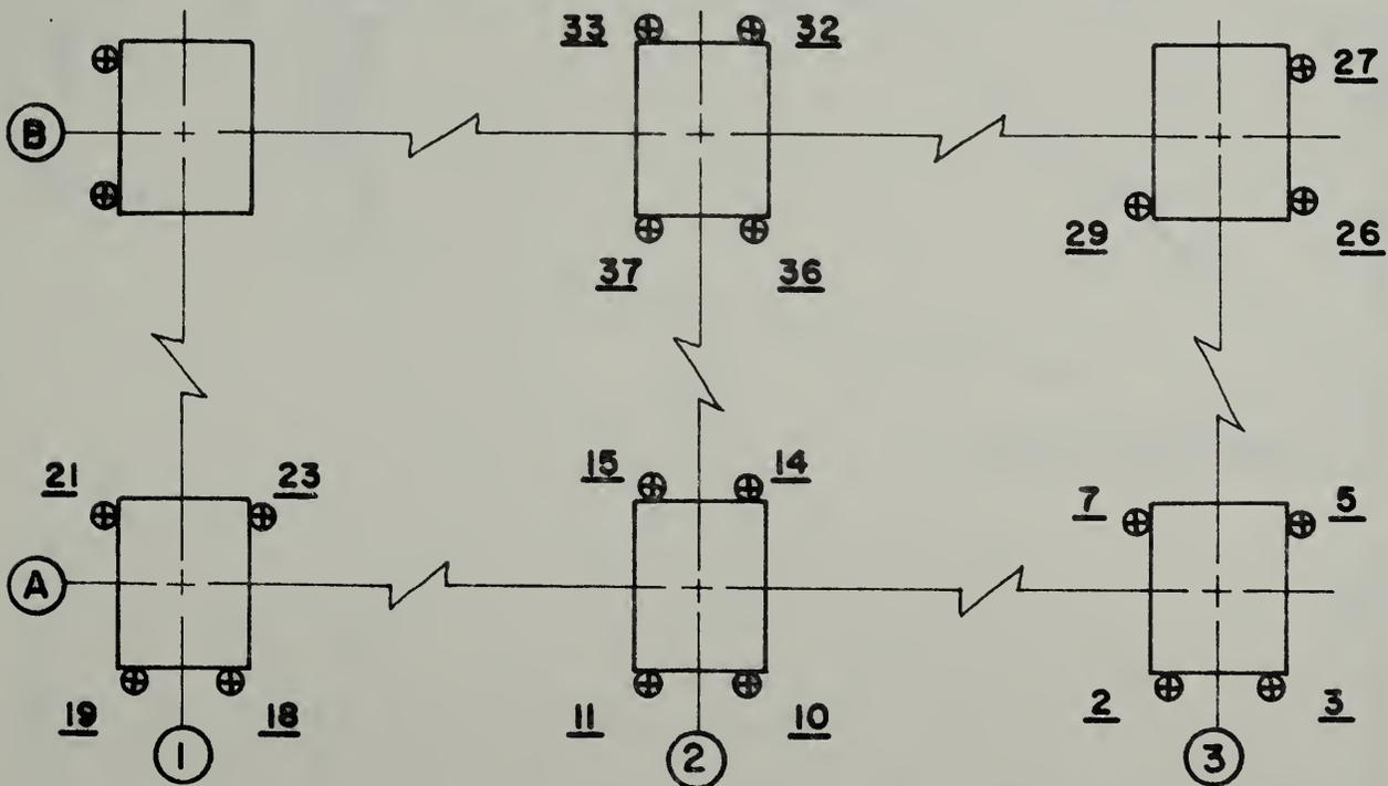
⊕ — TYPE A-3 STRAIN GAGE LOCATED
