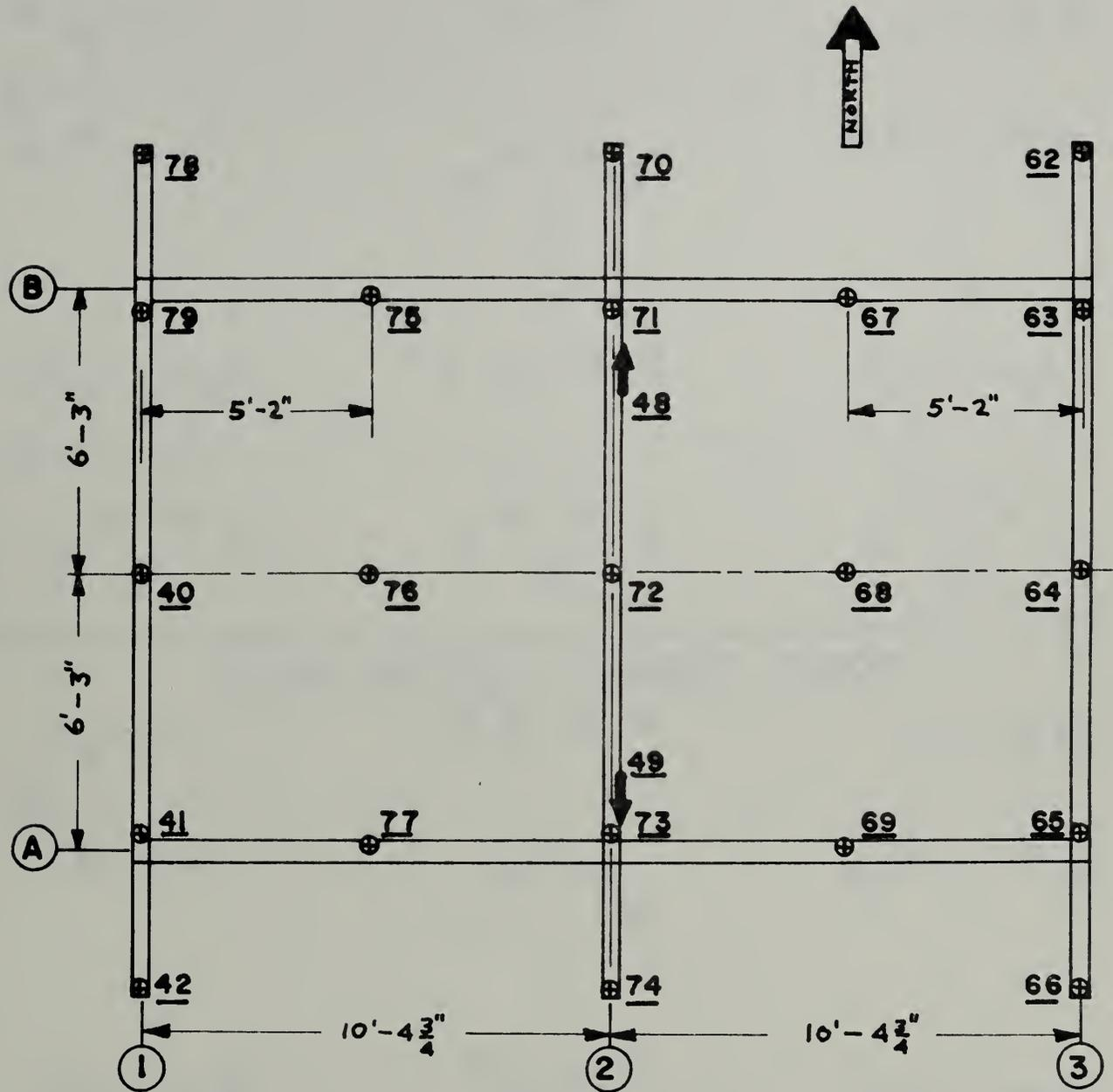
⊕ - LINEAR VARIABLE DIFFERENTIAL TRANSDUCER - VERTICAL
