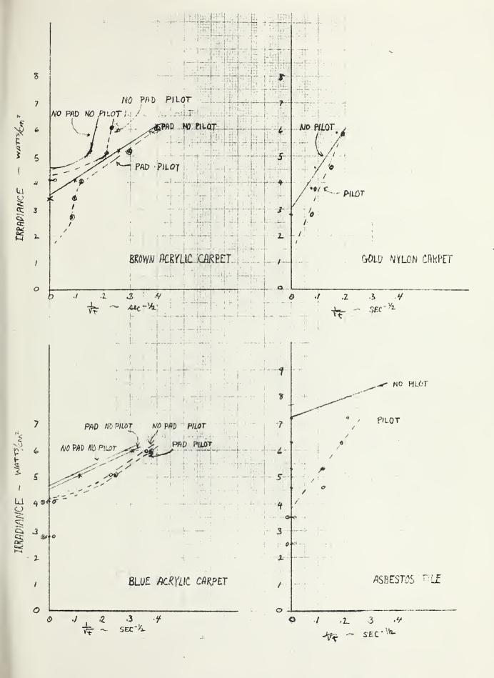
FIGURE 5 - TLOTO FOR ESTIMATING CRITICAL IRRADIANCE
