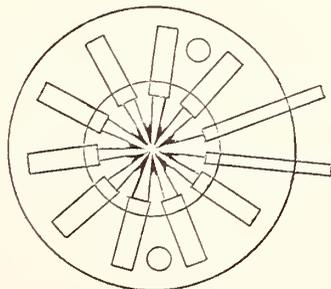
Fig. 6 Radiation Pyrometer-Thermopile
