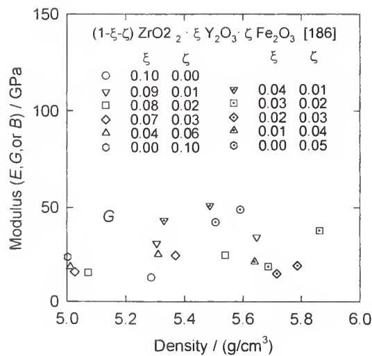
$ZrO_2 \cdot xY_2O_3 \cdot yFe_2O_3$  (cubic) { zirconia,  $Y_2O_3$ (c),  $Y_2O_3$ -stabilized cubic zirconia }
