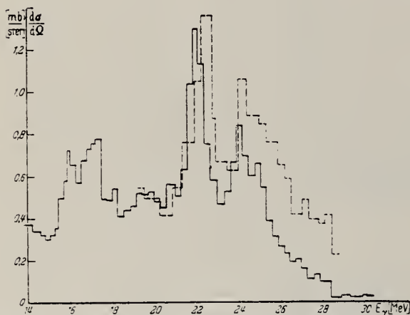
Fig. 6. Differentieller Wirkungsquerschnitt für Photoprotonenemission aus O 14 unter 90° zum γ-Strahl unter der Annahme, daß nur Grundzustandsübergänge vorliegen (—). Differentieller Wirkungsquerschnitt für Photoneutronenemission aus O 14 unter 90° nach FUCHS und HAAG* (---)
