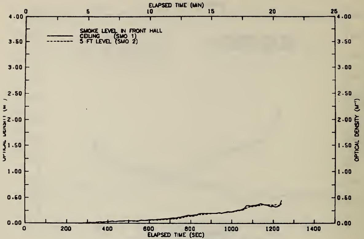
FIGURE A97 SMOKE LEVELS IN FRONT HALLWAY-TEST 10
