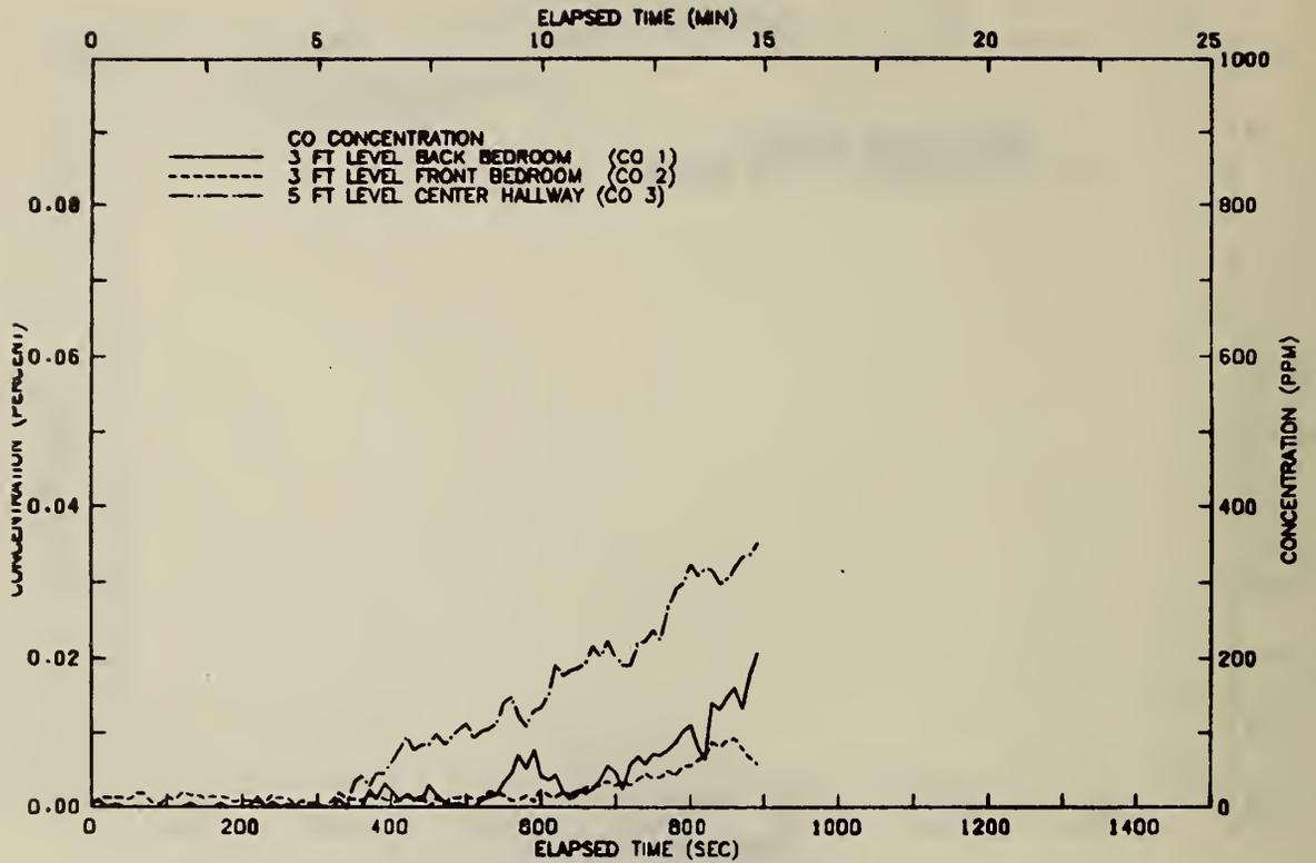
FIGURE A120A CARBON MONOXIDE CONCENTRATION-TEST 12
