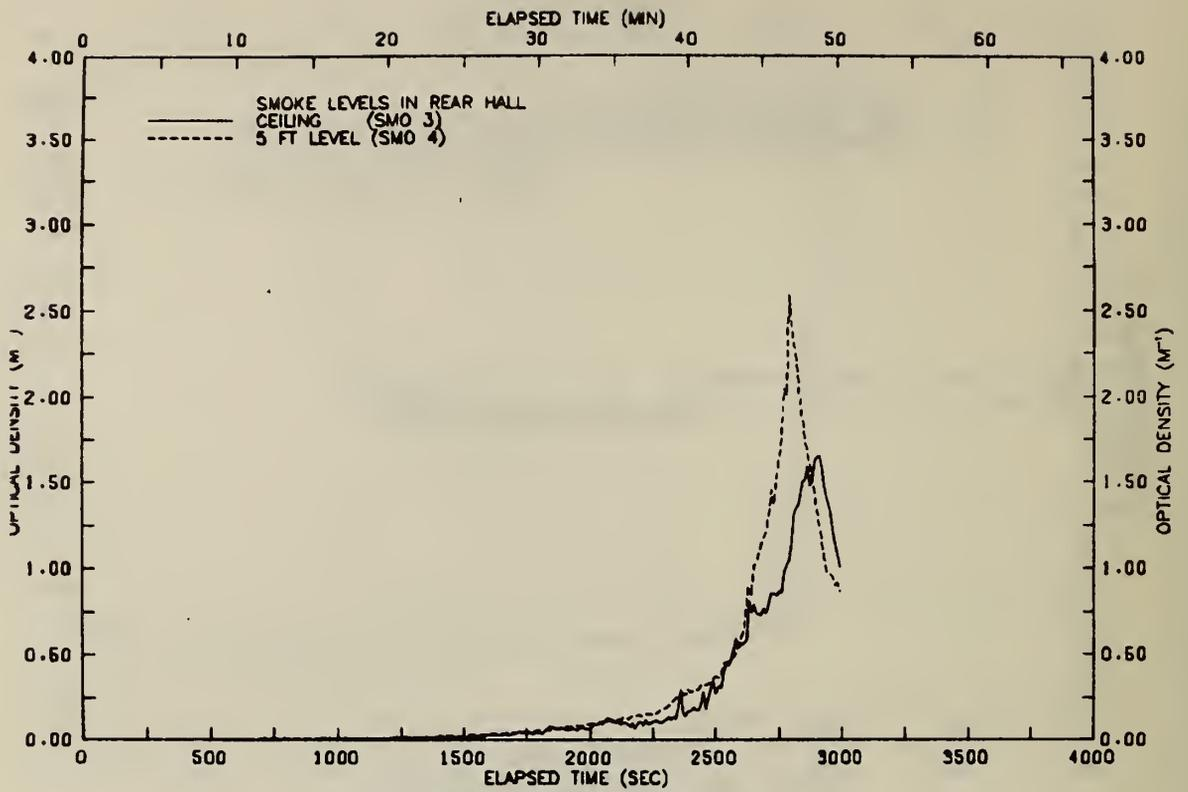
FIGURE B19 SMOKE LEVELS IN REAR HALLWAY-TEST 15
