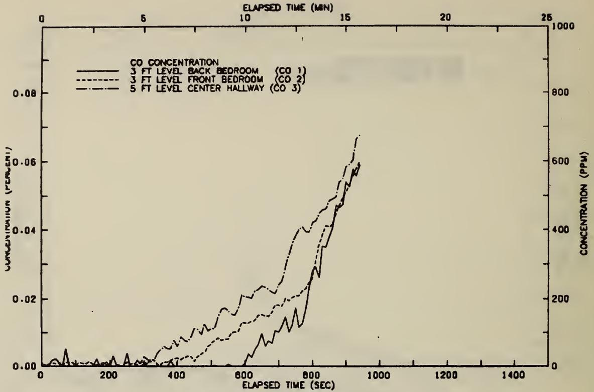
FIGURE A90A CARBON MONOXIDE
