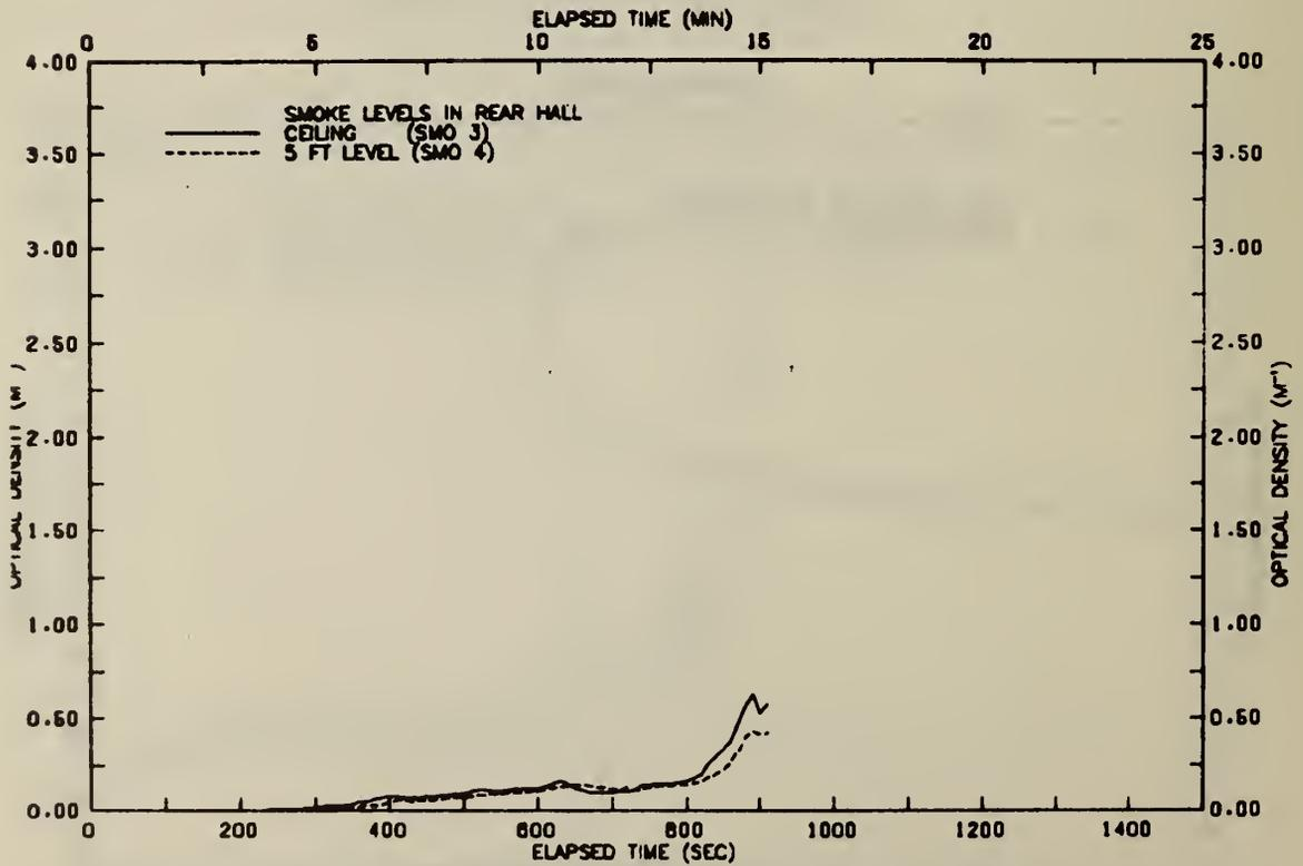
FIGURE A128 SMOKE LEVELS IN REAR HALLWAY-TEST 13
