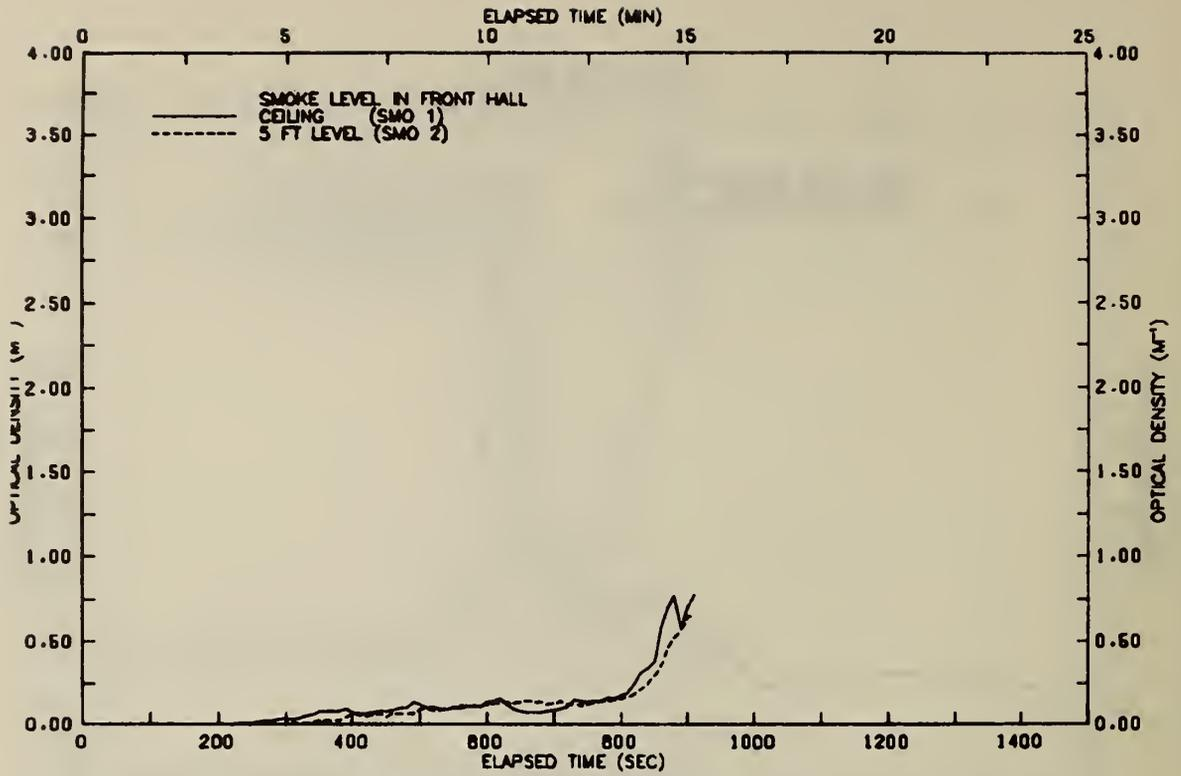
FIGURE A127 SMOKE LEVELS IN FRONT HALLWAY-TEST 13
