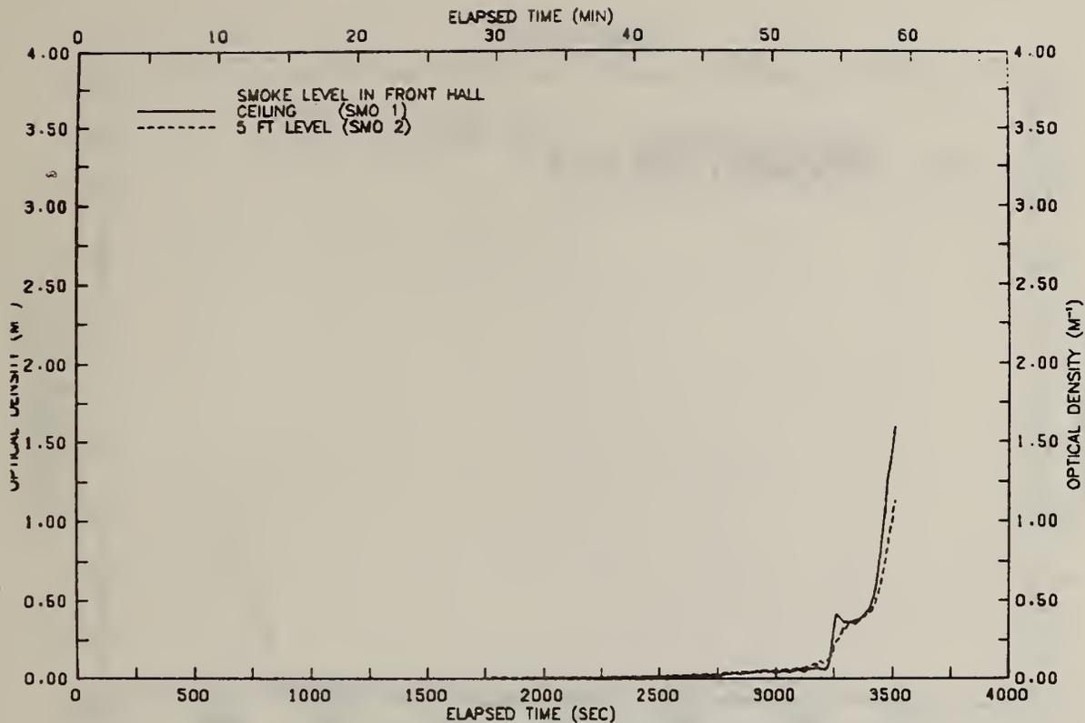
FIGURE B29 SMOKE LEVELS IN FRONT HALLWAY-TEST 16
