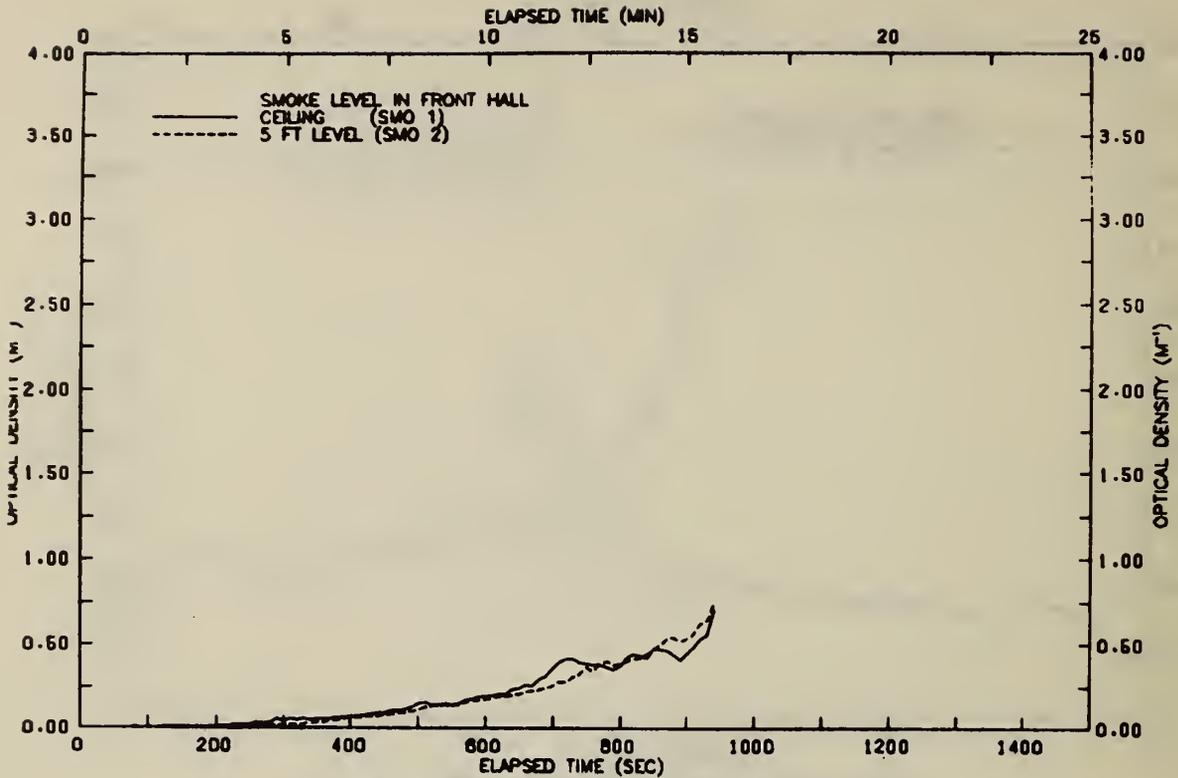
FIGURE A87 SMOKE LEVELS IN FRONT HALLWAY-TEST 09
