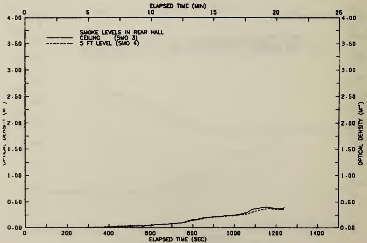
FIGURE A98 SMOKE LEVELS IN REAR HALLWAY-TEST 10
