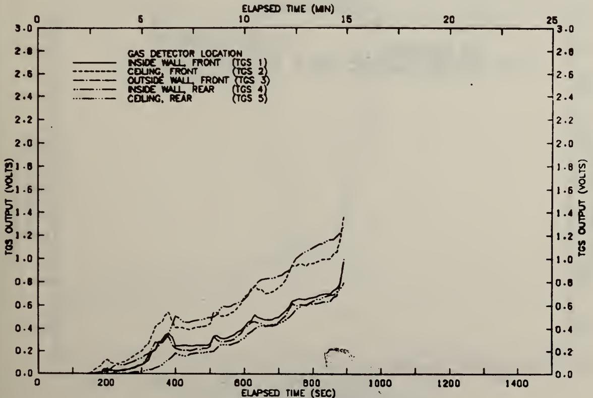
FIGURE A120 GAS DETECTOR OUTPUT
