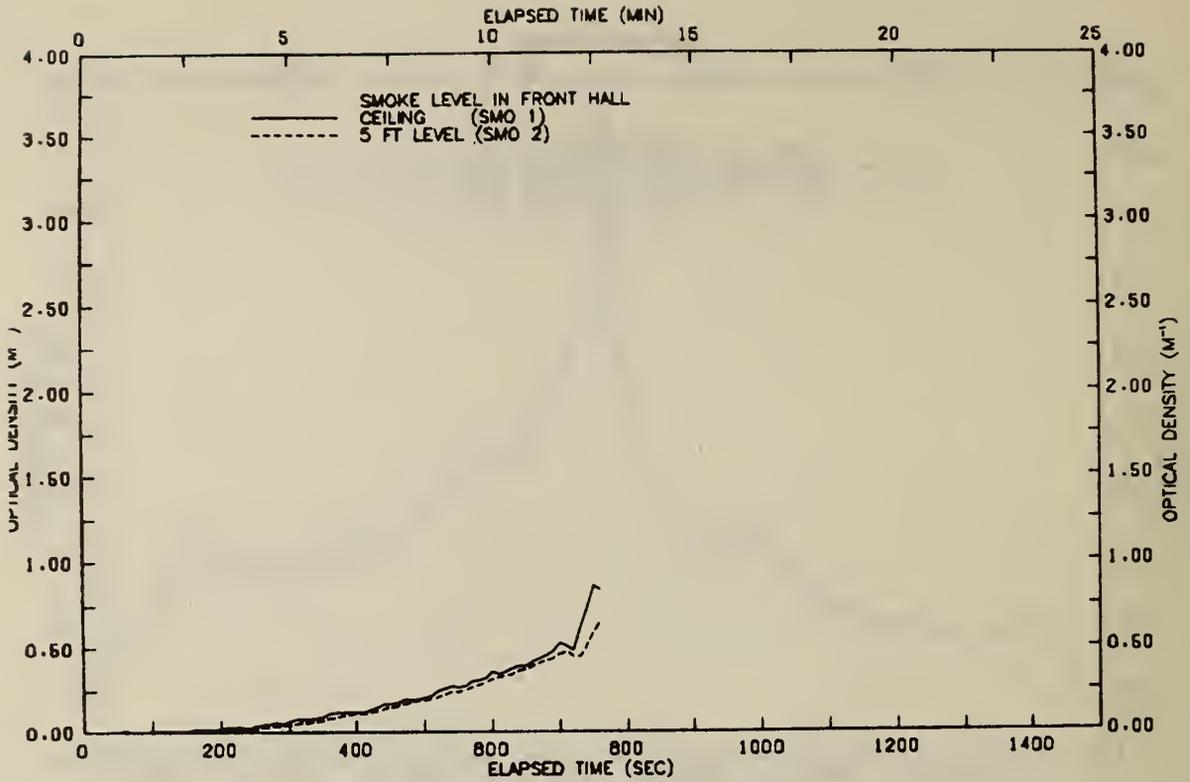
FIGURE B95 SMOKE LEVELS IN FRONT HALLWAY-TEST 22
