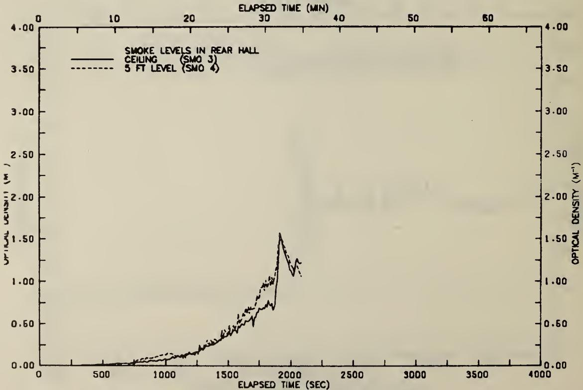
FIGURE A8 SMOKE LEVELS IN REAR HALLWAY-TEST 01
