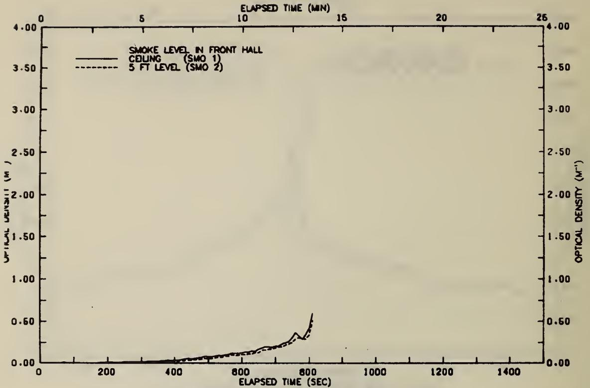
FIGURE A77 SMOKE LEVELS IN FRONT HALLWAY-TEST 08
