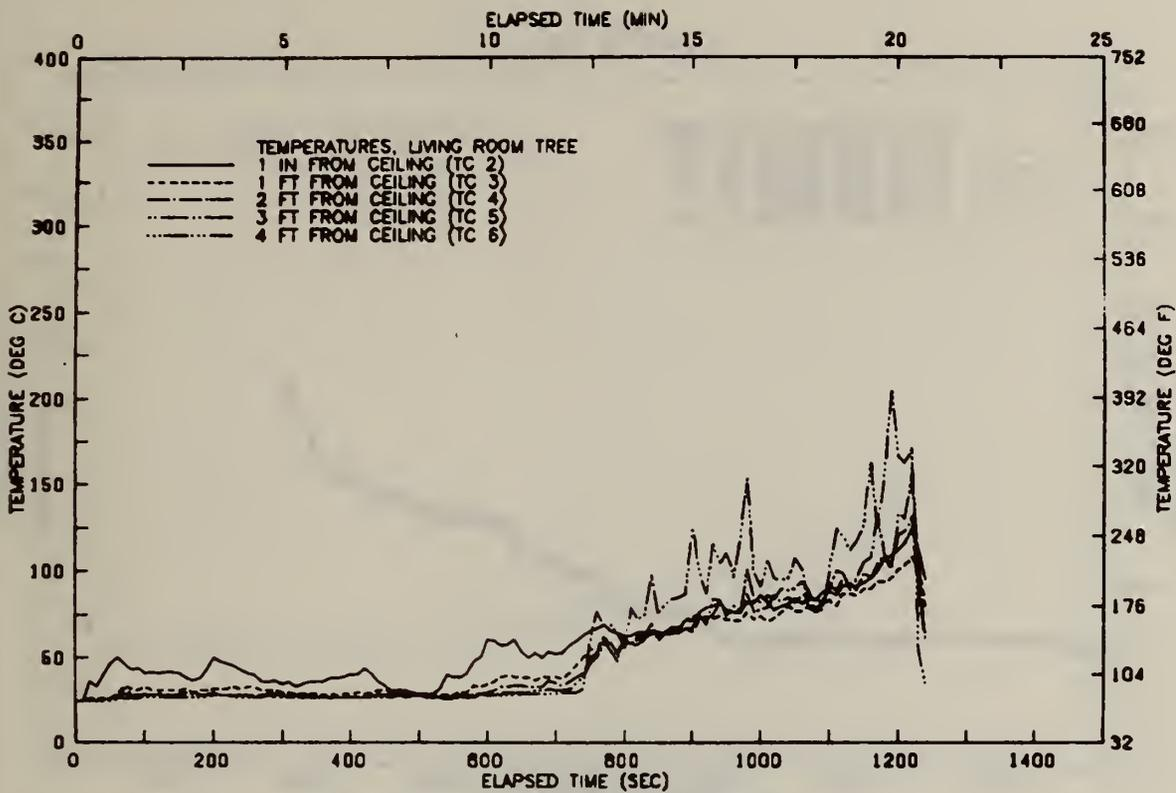
FIGURE A91 VERTICAL TEMP. PROFILE ABOVE CHAIR-TEST 10
