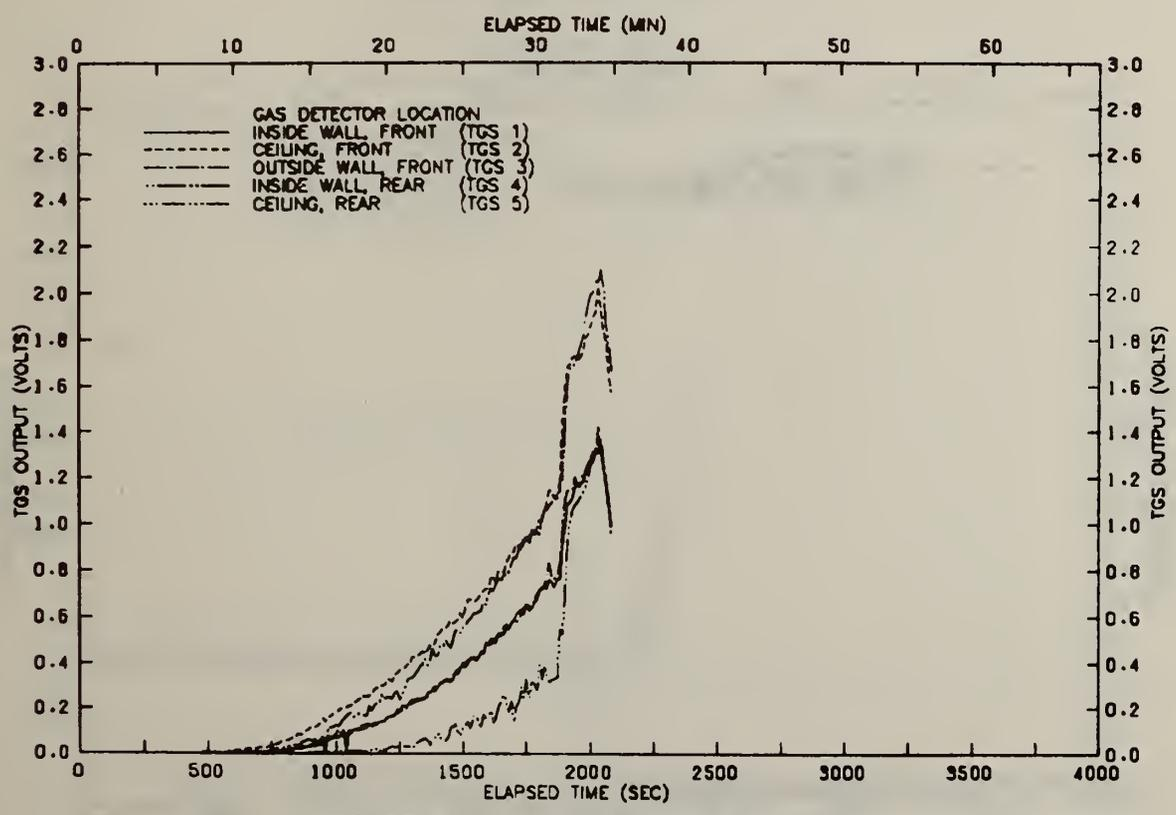
FIGURE A10 GAS DETECTOR OUTPUT VOLTAGE BY LOCATION-TEST 01
