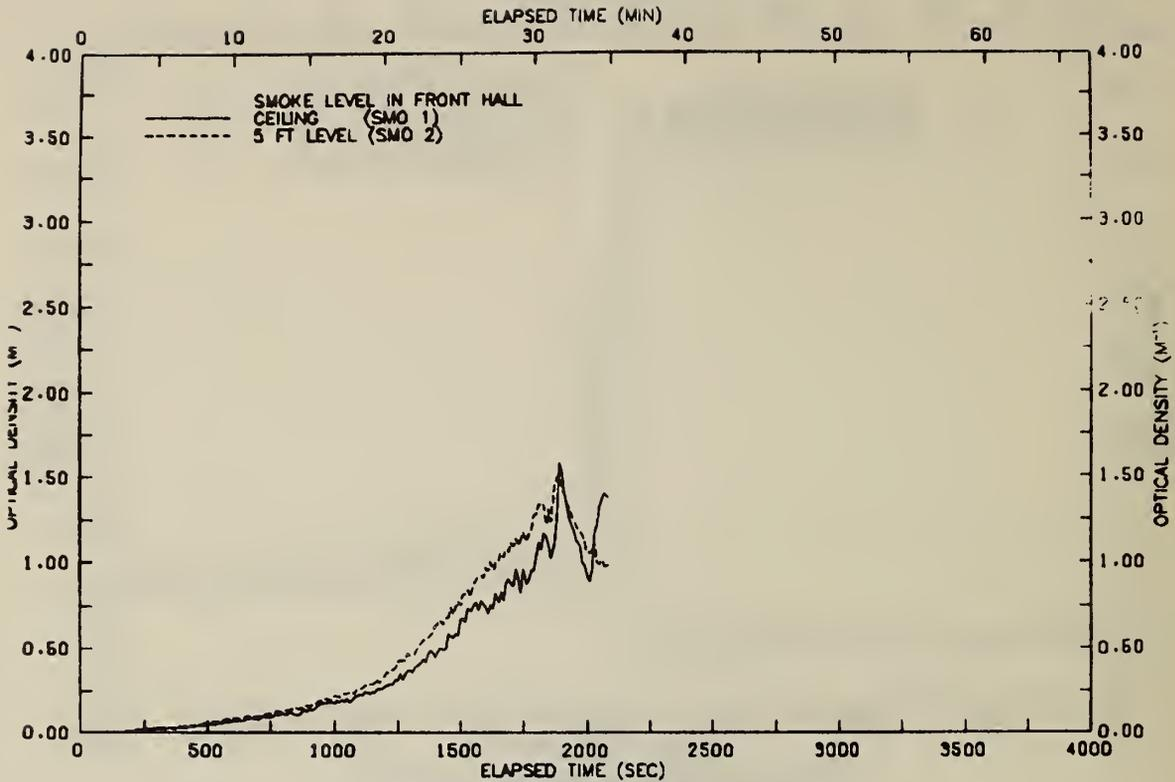
FIGURE A7 SMOKE LEVELS IN FRONT HALLWAY-TEST 01
