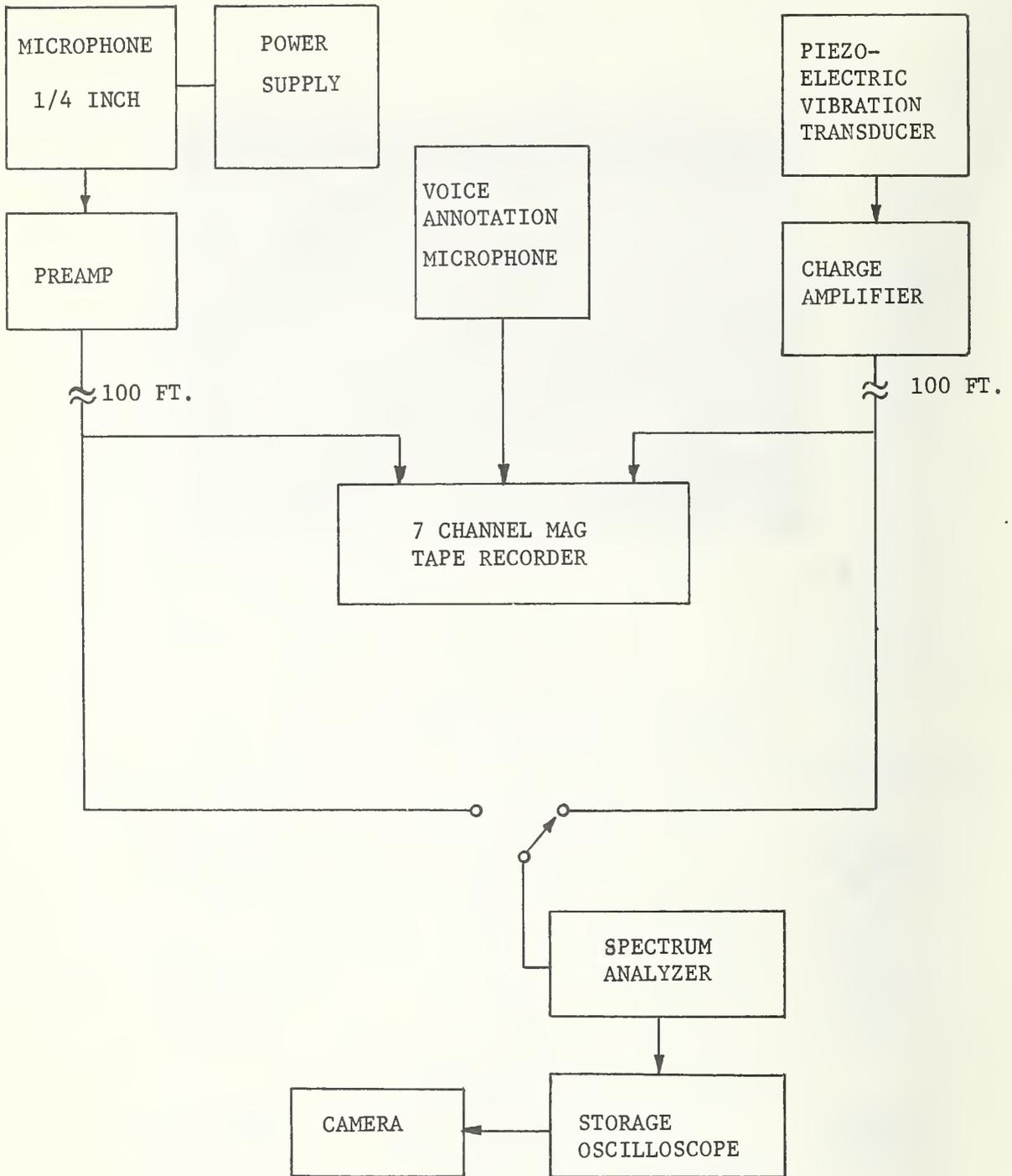
Figure 4. ACOUSTIC, ULTRASONIC AND VIBRATIONAL DATA RECORDING INSTRUMENTATION
