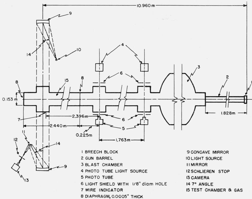
FIGURE 1. *Experimental apparatus.*
